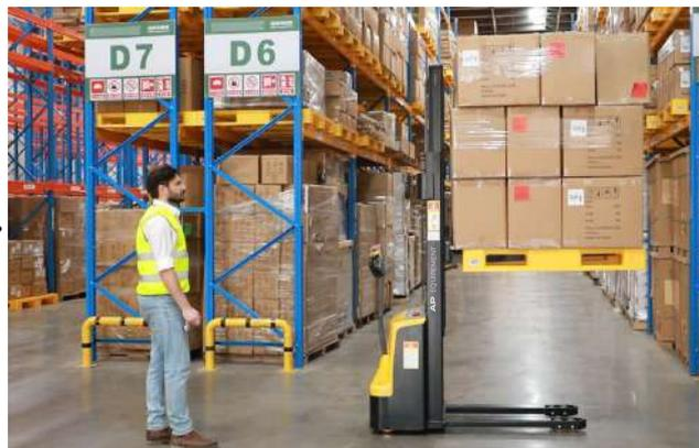
Avec le dispositif de télécommande, vous pouvez facilement régler la vitesse adaptée au travail, de la vitesse 1 à la vitesse 5. Ces transitions de vitesse vous permettent de déplacer le chariot avec une opération contrôlée en toute simplicité.
