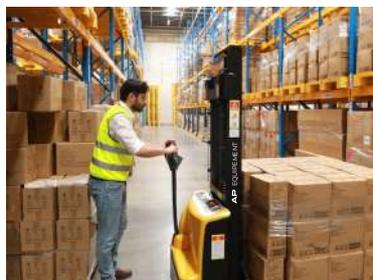
Facilement manœuvrable avec la poignée en position verticale en appuyant sur le bouton de vitesse lente.
