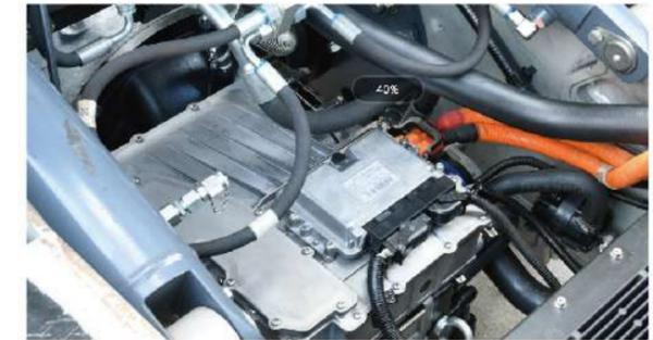
Le système d'alimentation intégré réduit le faisceau de câbles, ce qui réduit considérablement la perte de transmission de l'énergie électrique. Et les niveaux de pièces et de modules de contrôle sont clairs et pratiques pour la maintenance ;
