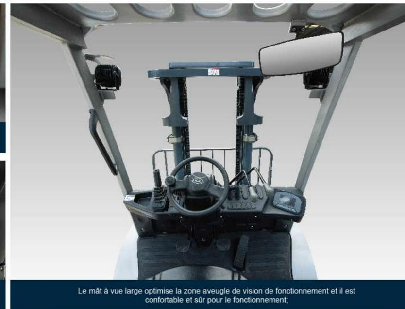
Le mât à vue large optimise la zone aveugle de vision de fonctionnement et il est confortable et sûr pour le fonctionnement ;
