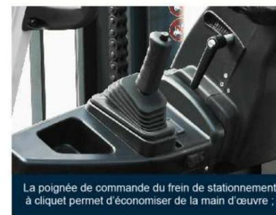
La poignée de commande du frein de stationnement à cliquet permet d'économiser de la main d'œuvre ;
