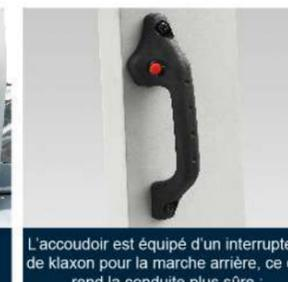
L'accoudoir est équipé d'un interrupteur de klaxon pour la marche arrière, ce qui rend la conduite plus sûre ;
