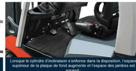
Lorsque le cylindre d'inclinaison s'enfonce dans la disposition, l'espace supérieur de la plaque de fond augmente et l'espace des jambes est agrandi ;
