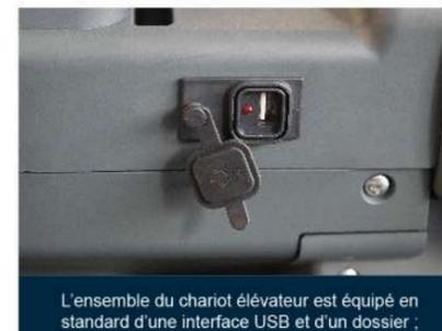
L'ensemble du chariot élévateur est équipé en standard d'une interface USB et d'un dossier ;
